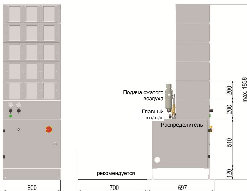
Установка и монтаж
